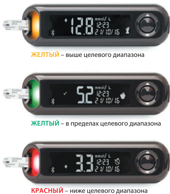
Рис. 2. Иллюстрация функции «Умная подсветка» (Smartlight™) глюкометра Контур Плюс Уан в зависимости от уровня глюкозы крови.
